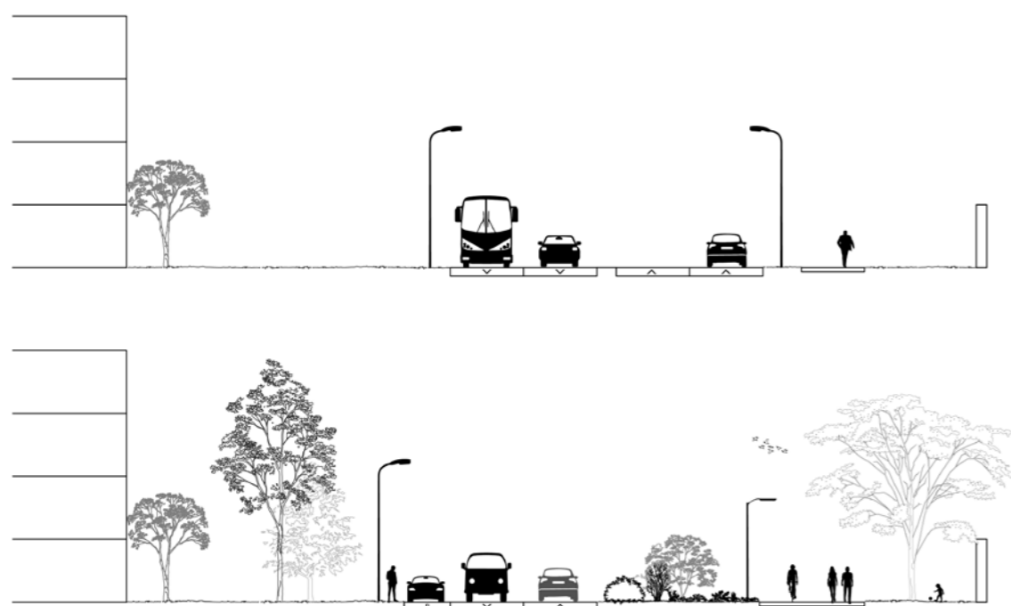
Proměna Plzeňské ulice z komunikace I. třídy na městskou ulici. Příčné řezy - stav a návrh.
