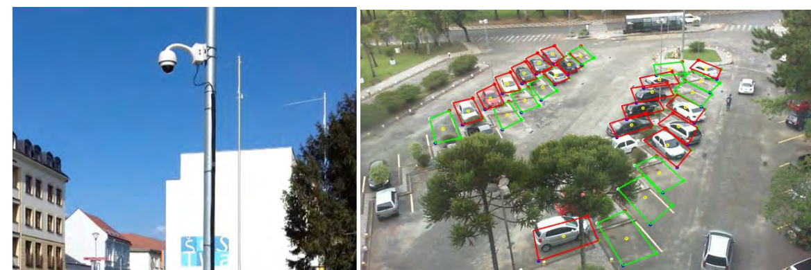
Obrázek 27 Detekce parkovacích míst pomocí dohledového systému ( https://www.google.obrazky.cz/ )
