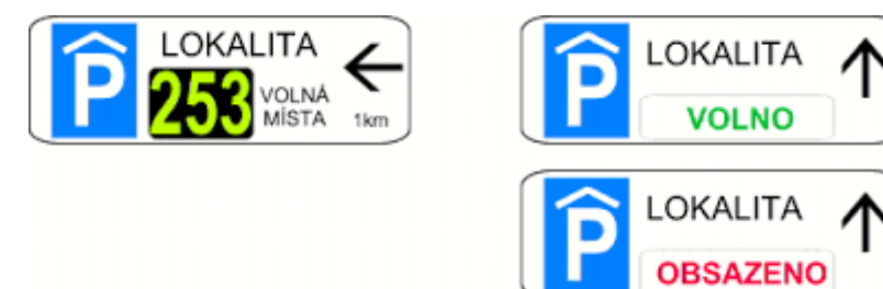
Obrázek 23 Příklad použití navádění pomocí tabulí – ITP ( https://www.google obrázky.cz/ ).
