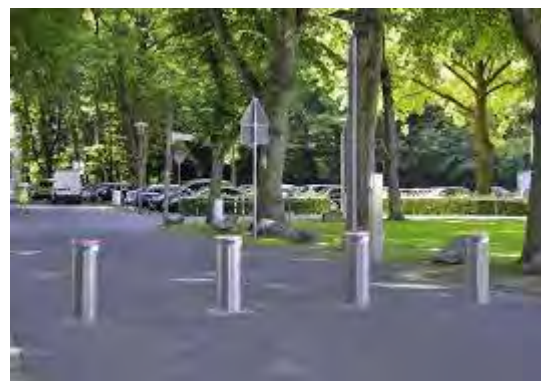
Obrázek 20 Ukázka hydraulických vjezdových sloupů a jejich použití (podklad: https://www.ynt.cz/ , https://www.hormann.cz/ )
